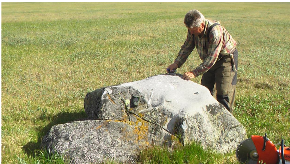
Рис. 31. Валун долерита в т.н. 1957-2 с приготовлением выпилования из него образцов для анализа содержания в камне космогенных изотопов хлора и берилия.
