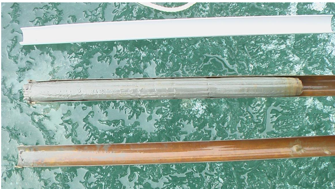
Рис. 8. Колонка донных отложений № 3 длиной 57 см из оз. Долгого во вкладыше грунтовой трубки ГОИН-1,5 на озёрном льду.
